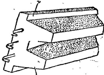
1.º Original configuração de viga, caracterizada pelo fato da sua seção transversal, apresentar-se no formato de cone truncado duplo retilíneo e paralelo de base plana formada com duas projeções laterais retangulares em toda a extensão. — Total de 2 pontos.
