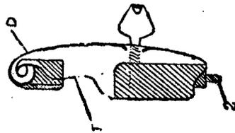
1.º) Novo modelo de fechadura, caracterizado por possuir uma tampa fôrmo de formato trapezoidal, confeccionada em única peça e chapa, a qual, dobrada sobre si mesma e vazada em posições locais originais e adequados, apresenta aberturas destinadas à intromissão do dente do trinco lingueta e da chave no respectivo tambor.
