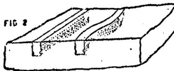
1.º Perfilado plástico para a decoração de pisos e paredes, caracterizado pelo fato de serem formadas varas coloridas de seção "I" ou seja retangular com dois canais ou reentrâncias de fundo arredondado, que se defrontam abaixo da linha mediana das paredes maiores. — Total de 2 pontos.
